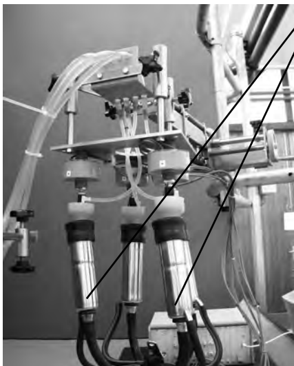
Bild 1: Testmodell mit universeller Einstellmöglichkeit der Zitzenposition
