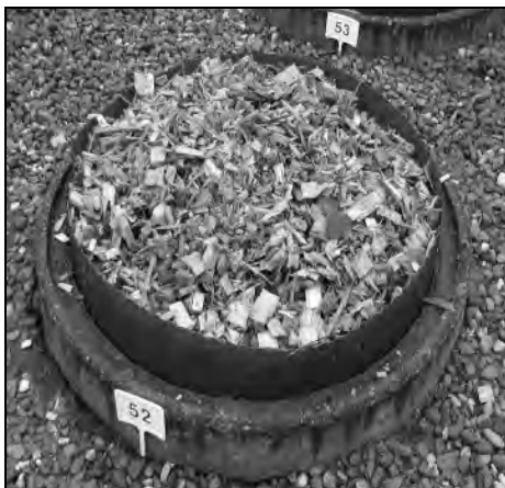
Abb. 2: Abdeckung des Lysimeters mit Holz hackschnitzeln (links), Stroh-Sandgemisch (rechts) und ohne Abdeckung (rechts hinten)
