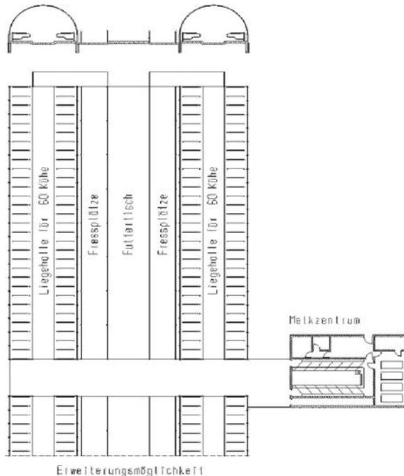
Abb. 2: Folienställe: Planungsstudie für eine Milchviehanlage mit 2 x 60 Liegeboxen und Schieberentmischung
