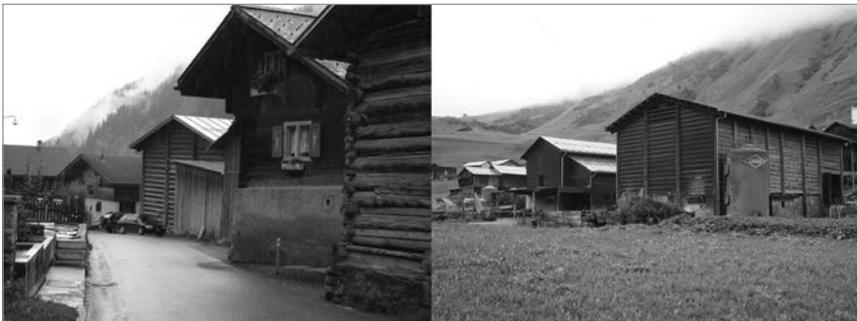
Abb. 3: Neue Ökonomiegebäude in Cons, Strassenansicht und Rückansicht, GR. Das notwendige Raumvolumen wurde auf zwei Gebäude aufgeteilt. Die neuen Gebäude passen sich mit ihrer Dimension an die der bestehenden Gebäude an
