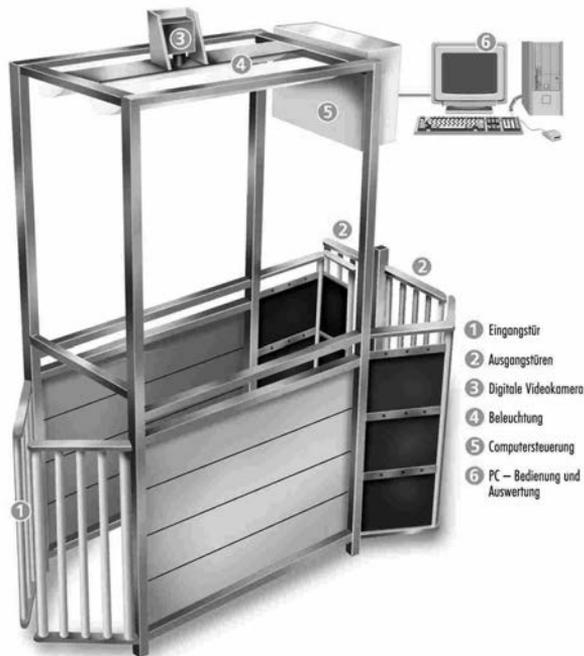
Abb. 1: Aufbau und Funktionsweise der optiSORT-Anlage
