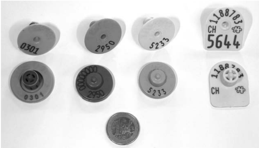
Abb. 1: Getestete elektronische und Kunststoff-Ohrmarken
