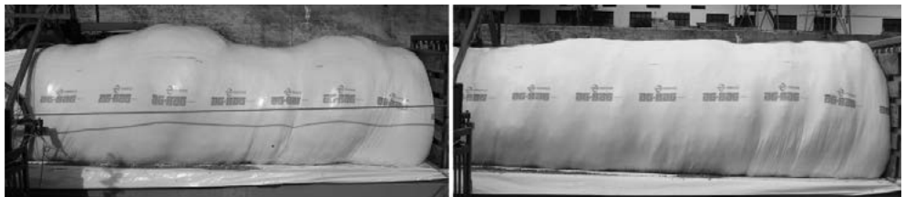
Abb. 4: Versuchsschlauch mit Rampen ohne Pressdruckanpassung (links) und mit automatischer Druckanpassung (rechts)
