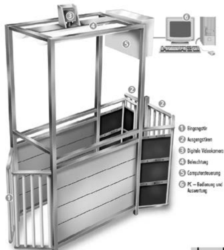
Abb. 1: Aufbau der optiSORT Sortierschleuse
