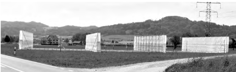
Abb. 3: Gerüst mit Folien zur Untersuchung der Verlagerung von Gasen zwischen den „Versuchsbereichen“ des geplanten Stalls zu unterschiedlichen Windbedingungen
