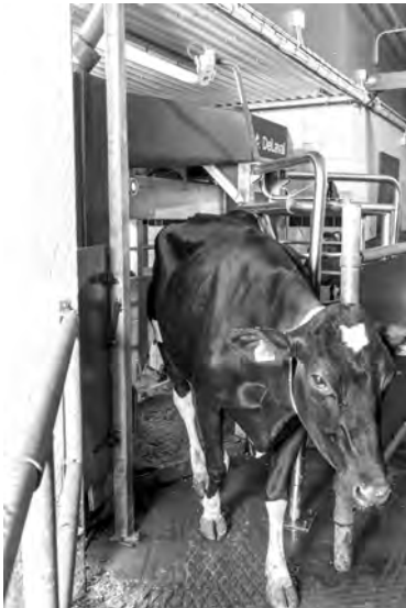
Abb. 1: BCS-Kamera, Montage oberhalb des VMS Ausgangstors
