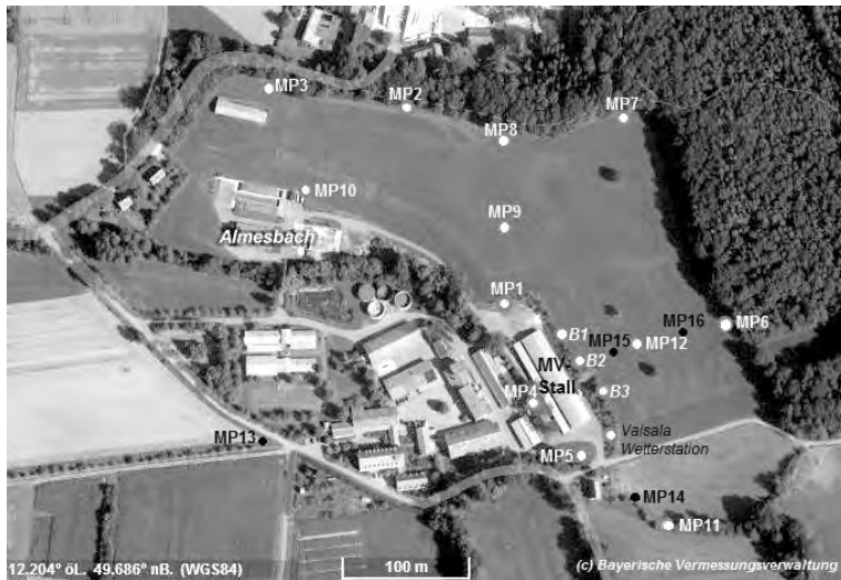
Abb. 1: Messpunktpositionen (Stand 03/2015) (MP – Passivsammler, B – Bulksammler)
