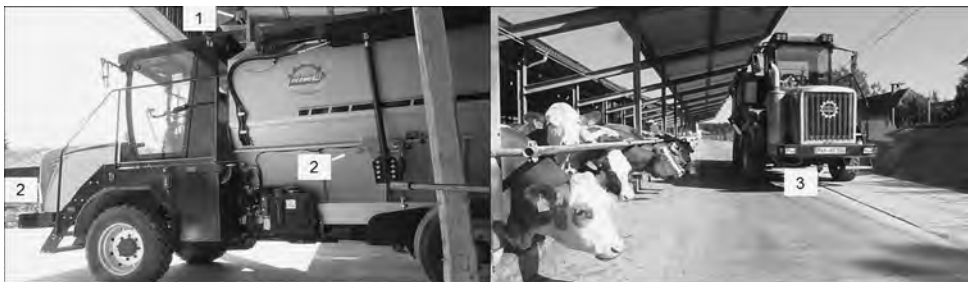
Abb. 1: Selbstfahrer-Futtermischwagen mit den angebrachten Sensoren (1 = Laserscanner zur Orientierung, 2 = Not-Aus-Systeme, 3 = Advanced Object Detection System (AOS))
