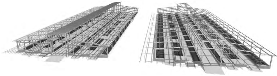
Abb. 1: Stallmodell in Holz- (links) bzw. Stahlbauweise (rechts)
