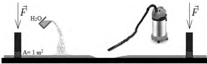
Abb. 1: Schematische Darstellung der Methode: Abgrenzung der Versuchsfläche mit der Restverschmutzung, Verdünnung mit Wasser und Absaugen
