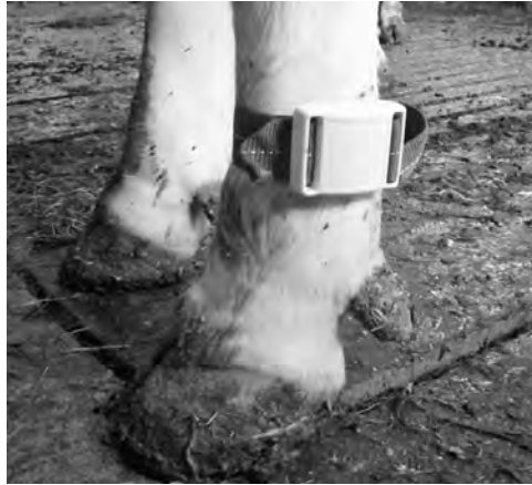
Abb. 1: ENGSt-Pedometer angebracht am Vorderfuß einer Versuchskuh
