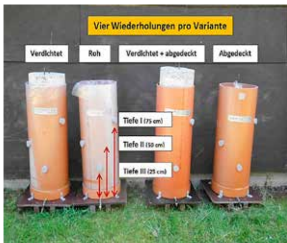
Abb. 1: Versuchsvarianten und Aufbau zur Bewertung vier unterschiedlicher Verfahren der Lagerung von festen separierten Gärresten in jeweils vier Wiederholungen und drei Probenahmetiefen
