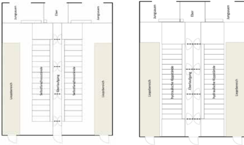
Abb. 2: Grundriss der Variante 1 (links) und Grundriss der Variante 2 (rechts), (© Görtz und Unangst) Fig. 2: Layout of version 1 (left) and layout of version 2 (right, © Görtz und Unangst)
