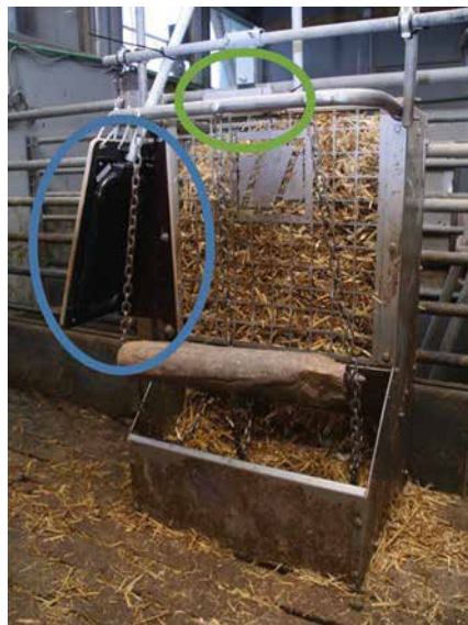
Abb. 1: UHF-Antenne (grün) und LF-Antenne (blau) am Beschäftigungsgerät „Porky Play“ (© Eckert) Fig. 1: UHF antenna (green) and LF-antenna (blue) at the playing device „Porky Play“ (© Eckert)
