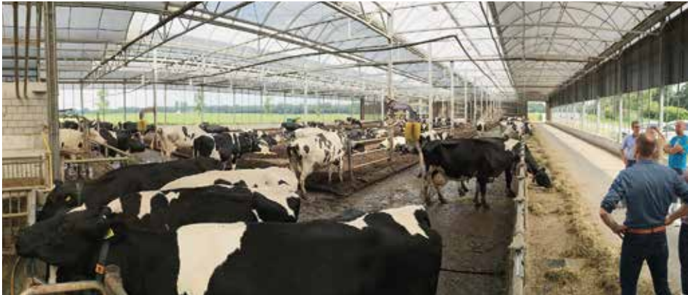
Abb. 1: Blick in einen Kompostierungsstall für 120 Kühe in den Niederlanden. Links befinden sich zwei AMS Einzelboxen, rechts der Futtergang und der Futtertisch, mittig die jederzeit zugängliche Liegefläche aus organischem Material. (© Büscher)
