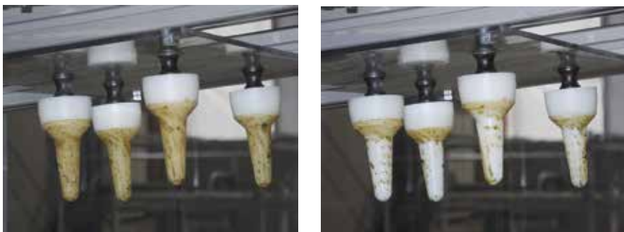
Abb. 1: Einfach verschmutzte glatte Prüfpitzen vor und nach der Reinigung (© Küver)
