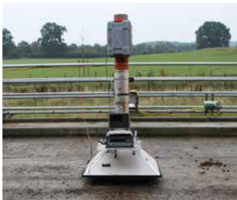
Abb. 1: Die aktive Probenahmehaube im Einsatz in einem Auslauf (© Winter)
