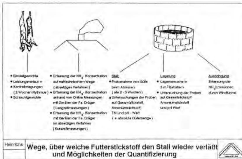
Abb. 2: Wege, über welche Futterstickstoff den Stall wieder verläßt und Möglichkeiten der Quantifizierung
