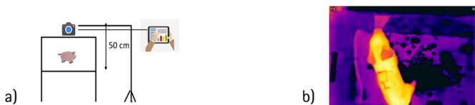
Abb. 1: a) Aufbau der Wärmebildaufnahmen, b) Beispielaufnahme Wärmebild (© S. Küster)
