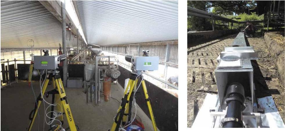
Abb. 1:  $\text{NH}_3$ - und  $\text{CO}_2$ -Diodenlaser-Spektrometer während der Messung in einem Milchviehstall (links); Messtunnel bei der Laufhofmessung (rechts) (© LfL, ILT)
