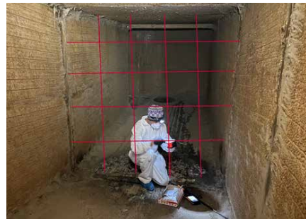
Abb. 1a, b: Ziehung von Geruchsproben an einem Kamin und in einem Abluftschacht (© M. Kropsch) Fig. 1a, b: Taking odour samples from a chimney and an exhaust shaft (© M. Kropsch)
