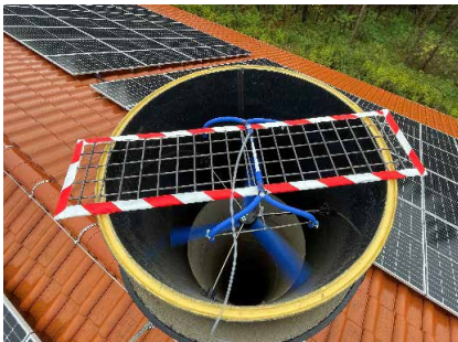
Abb. 1a, b: Ziehung von Geruchsproben an einem Kamin und in einem Abluftschacht (© M. Kropsch) Fig. 1a, b: Taking odour samples from a chimney and an exhaust shaft (© M. Kropsch)
