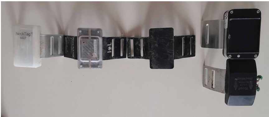
Abb. 1: Entwicklungsschritte des NECKTAG® von links nach rechts bis zum finalen NECKTAG® mit Solarpanel und EMS (© LfULG)
