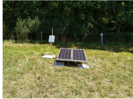
Abb. 1: Gehäuse des neu entwickelten Ortungssystems (links); LPWAN-Empfangsstation für die Lokalisierung der Rinder auf der Weide (rechts) (© J. Maxa)
